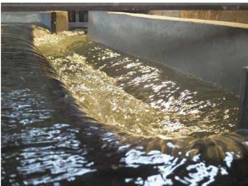
Obr. 5. Modelovanie bezpečnostného prepadu vodného diela. Zdroj: Archív VÚVH
