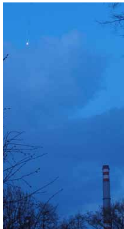
Obr. 1. Ukázka injektování markerů u průmyslových podniků vystřelováním náboje z pistole – bílá skvrna nahoře je explodující náboj s markerem (Ostrava, duben 2012). Foto: Jaromír Drápala
