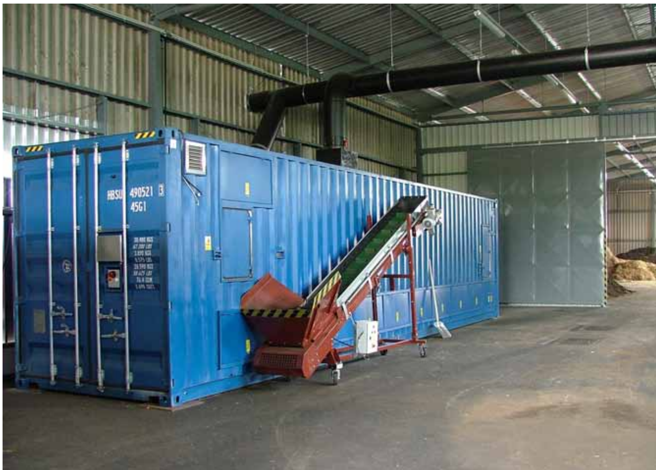
Obr. 1. Fermentor EWA 2014, vyráběný společností AGRO-EKO, spol. s r. o., Albrechtice (Česká republika), je inovativní technologie na zpracování biologicky rozložitelných odpadů včetně gastroodpadů, která získala certifikát ETV v roce 2016 (Jemnice Krakov, Polsko, 2018). Foto: Miroslav Hůrka
