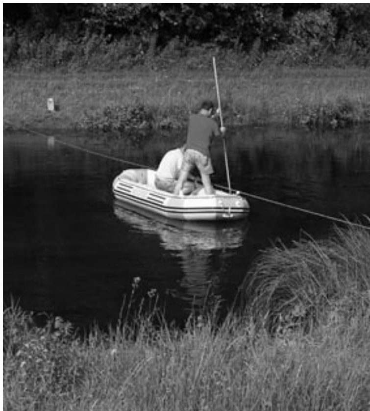
Obr. 3. Meranie hrúbky nánosov na kanáli Gabčíkovo – Topoľníky. Foto: Y. Velísková
