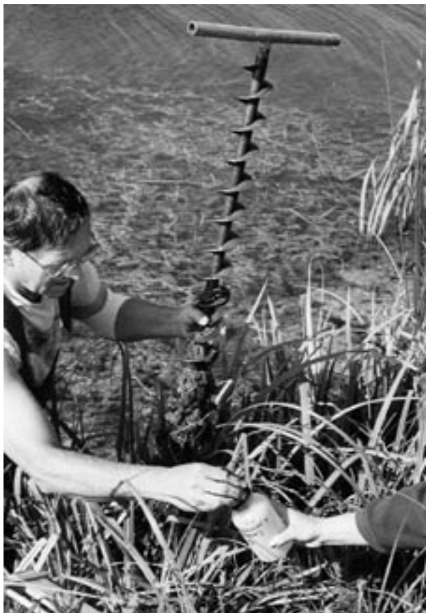
Obr. 4. Odoberanie vzoriek nánosov na jednom z kanálov Žitného ostrova. Foto: Y. Velísková
