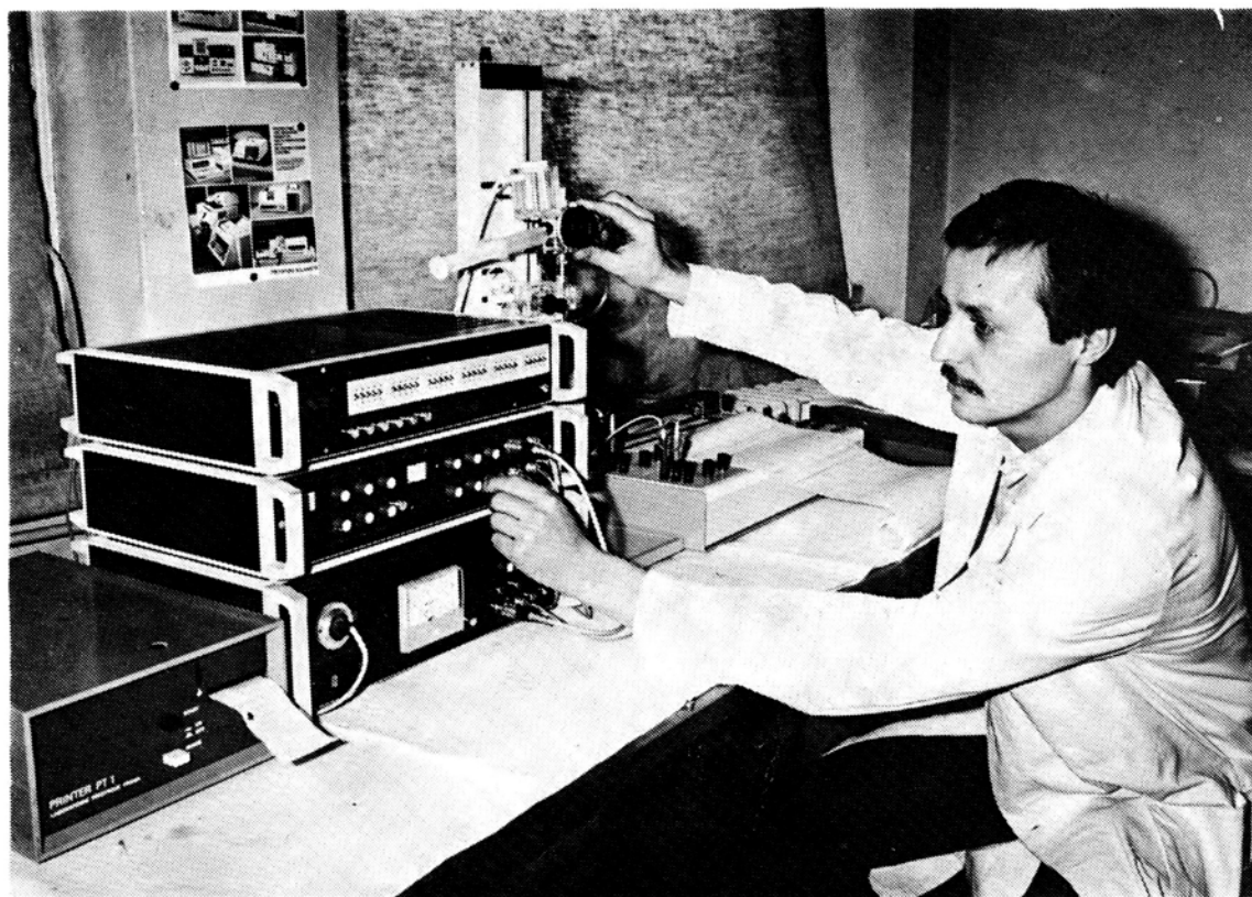
Obr. 2. Pracovisko SHMÚ — Laboratórium čistoty ovzdušia — vyhodnocovanie atmosférických zrážok metódou izotachoforézy.
